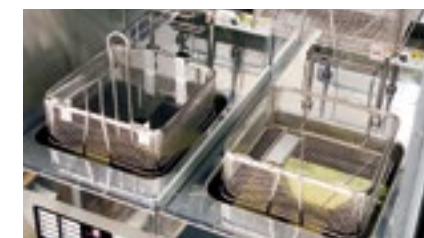
新型フライヤー IH方式に変更し、清掃も簡単に。
