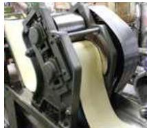
セブン - イレブンの各専用工場にうどんを切るための専用設備を導入し、茹で後に角立ちのある麺を実現。
